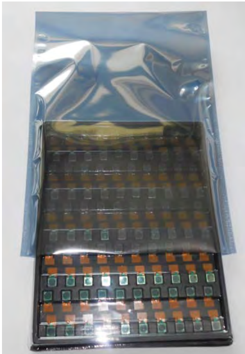
Mettere il vassoio nella borsa antistatica
